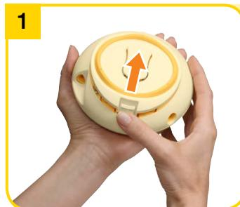
Öppna batterifacket på baksidan i den riktning pilen anger.
