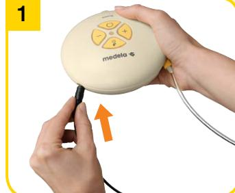
Koble strømadapterledningen til motorenheten.
